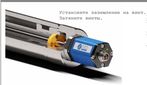
Замена базового блока (например, датчика MSI-H), часть 2
